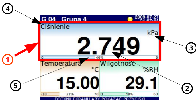
Rys. 6.8. Struktura Panelu pomiarowego
