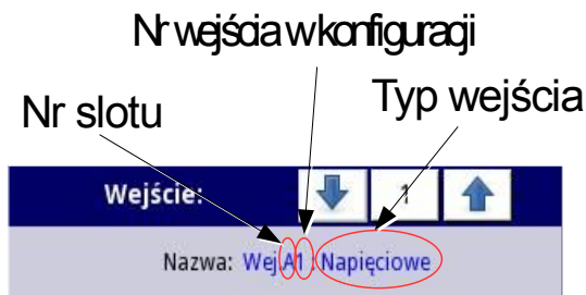
Rys. 7.82. Sposób zapisu Nazwy wejścia wbudowanego
